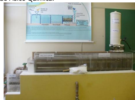
Miniinstalação de tratamento de Água
